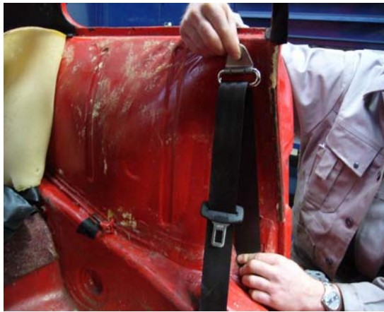
Abb. 5-4 Gurtbandführung durch die Karosserie in den Radkasten [22]
