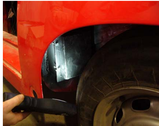
Abb. 5-4 Gurtbandführung durch die Karosserie in den Radkasten [22]
