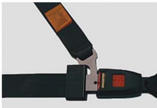
Abb. 5-8 Dreipunktgurt für Mittelsitze [24]
